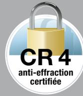
Un malfaiteur expérimenté tente de fracturer la porte verrouillée en 10 minutes avec des outils tels que des pieds-de-biche, des perceuses et des outils de percussion.
