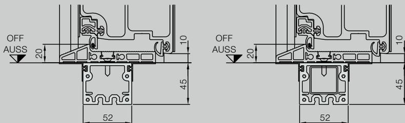
Pour les constructions monobloc, avec renfort tubulaire intérieur continu (illustration de droite).
