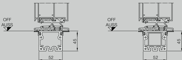
Pour les constructions monobloc, avec renfort tubulaire intérieur continu (illustration de droite).
