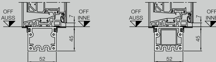
Pour les constructions monobloc, avec renfort tubulaire intérieur continu (illustration de droite).
