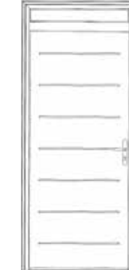
ÉQUATION HAUTEUR MAXIMUM AVEC IMPOSTE H 2350 L 900 Au-delà de 2250 mm, possibilité de mettre une imposte de 200 à 450 mm pour une hauteur maximum porte + imposte de 2350 mm.
