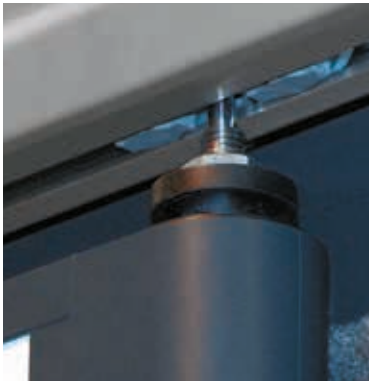
Galet emprisonné sur rail anti-déraillement.
