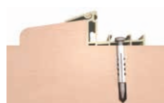
Fixation en rénovation
